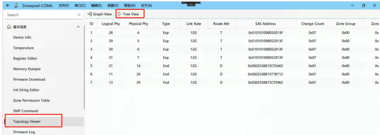
图 8 确认 EVB 板 PHY 接口已经激活
